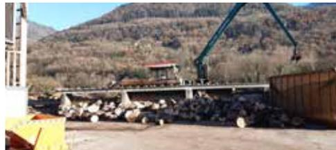
Une machine, appelée « petit train », attrape une grume avec une pince, place la grume sur un tapis, puis coupe avec une tronçonneuse la grume en morceaux selon les traits du technicien.
