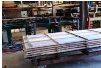
Les planches destinées à être utilisées à l'intérieur vont dans des séchoirs, les autres vont sécher dehors. Dans le séchoir, les planches sont d'abord mouillées, puis elles sont chauffées à 60°C environ pendant 2 à 5 semaines selon l'épaisseur des planches.
